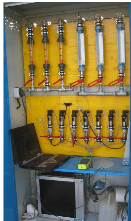
Abbildung 7: Messaufbau für Volumenstrom und Druckmessung
